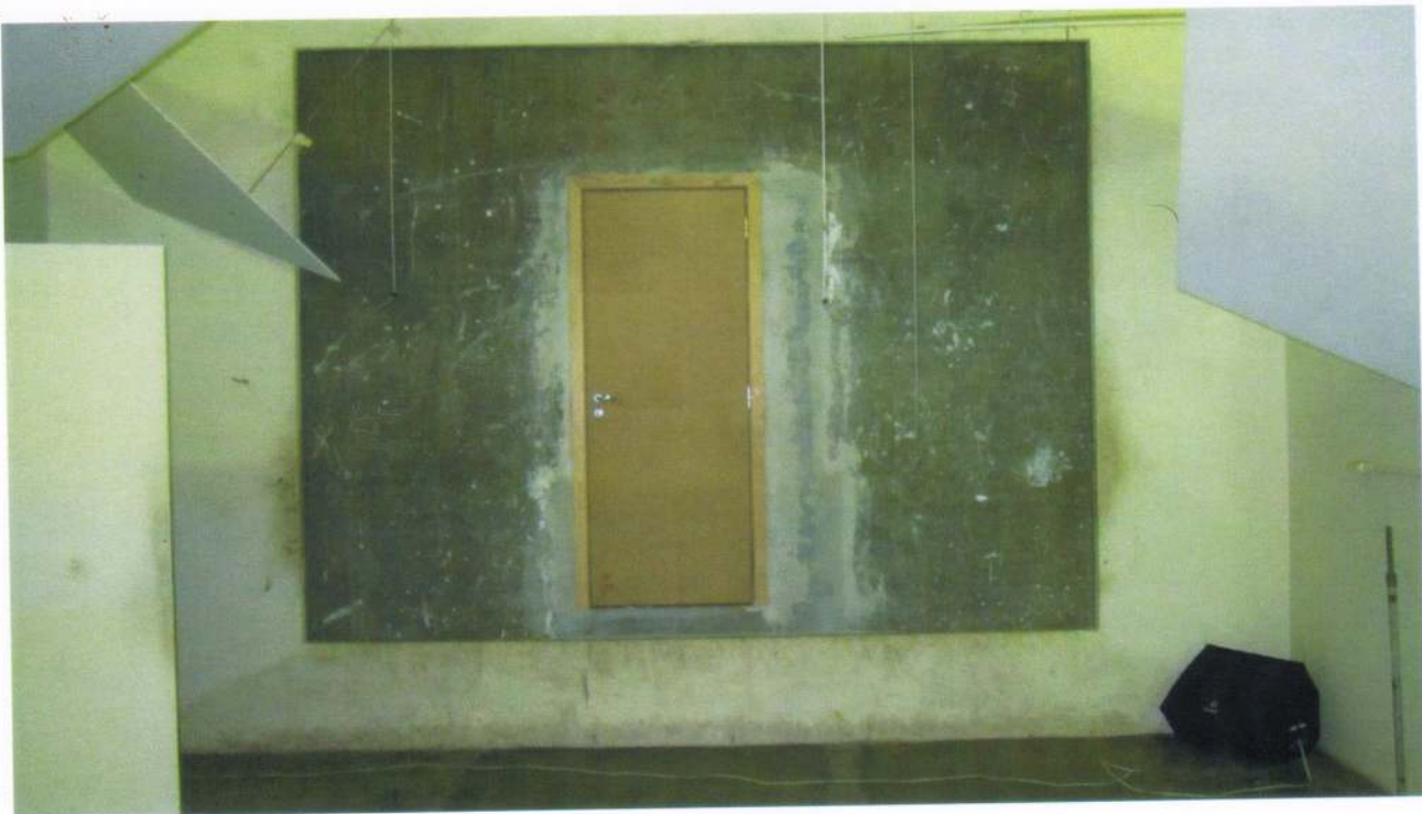
Foto 8: Porta posicionada na câmara de ensaio – face oposta à incidência do ruído
