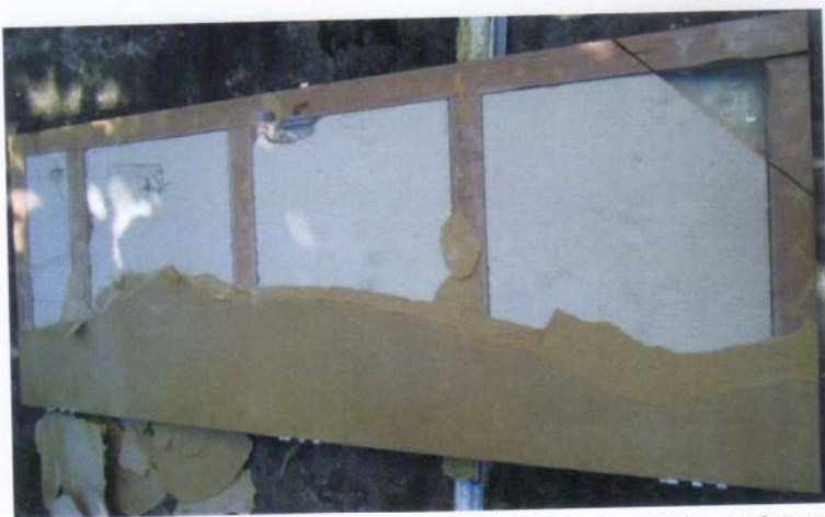
Foto 5: Folha de porta parcialmente dissecada após ensaio – notam-se a capa, montantes, travessas, enchimento do miolo e, no vértice recortado, a chapa de aço ao fundo
